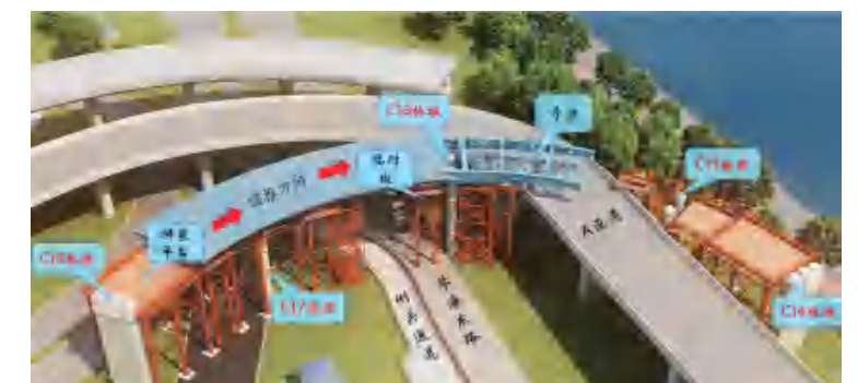
图 4 顶推施工临时结构组成 3D 示意图
